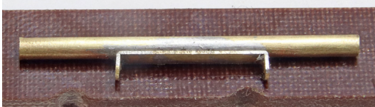
U mittig auf die Achse löten.
