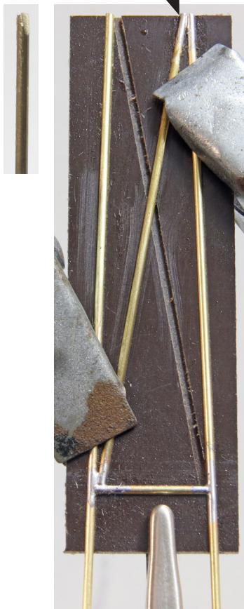
Diagonale oben leicht anschrägen.
